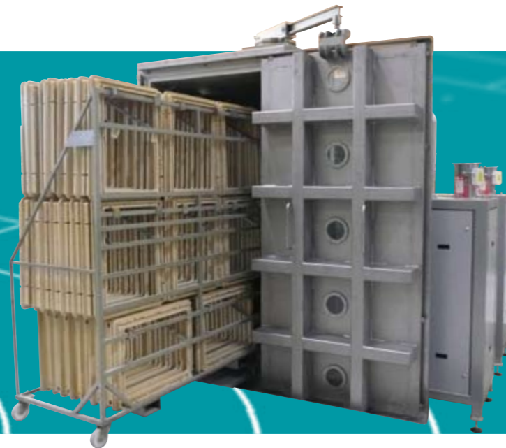
Vakuumkammer für die PVD-Beschichtung Der Rezipient ist doppelwandig und wassergekühlt.
