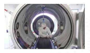
Wir entwickeln und produzieren Vakuumkammern sowie Thermalanlagen zum Testen von Satellitenbauteilen, Sonnensegeln und Kleinsatelliten. Kälte simulieren wir bis -190° C und Wärme bis 200°C und erzeugen Vakuum, polymergedichtet bis 1 x 10E-8mbar oder metallgedichtet bis ins Hochvakuum.
